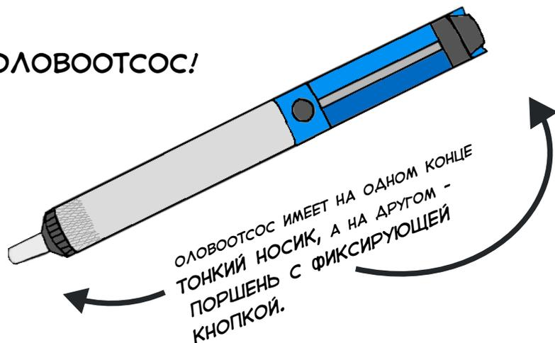
ВНУТРИ РАСПОЛОЖЕНА ПРУЖИНА, КОТОРАЯ ПРИ НАЖАТИИ НА
